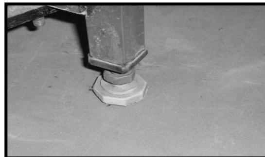
Esta banheira possui 210 x 80 cm (diâmetro x altura). Esta banheira não necessita de assentamento. Ela possui pés niveladores que devem ser ajustados para corrigir as imperfeições do piso. Os pés se ajustam até 4 cm de altura. O espaço que sobra entre os painéis de fechamento frontal e lateral e o piso (entre 0,5 e 4 cm) serve como entrada e saída de ar.
